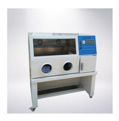
DRK659 厌氧培养箱是一种可在无氧环境下进行细菌培养及操作的专用装置,可培养最难生长的厌氧生物在大气中操作时接触氧而死亡的危险性。厌氧培养箱亦称厌氧工作站或厌氧手套箱。厌氧培养箱是一种在无氧环境条件下进行细菌培养及操作的专用装置。它能提供严格的厌氧状态恒定的温度培养条件和具有一个系统化、科学化的工作区域。该产品是一种可在无氧环境下进行细菌培养及操作的专用装置,可培养最难生长的厌氧生物,又能避免往厌氧生物在大气中操作时接触氧而死亡的危险性。因此本装置是厌氧生物检测科研的理想工具。
