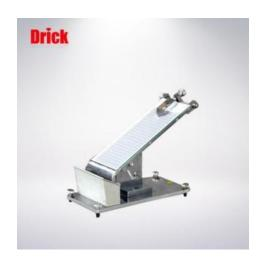
DRK129 初粘测试仪主要用于胶粘带、标签、医用胶带、保护膜、膏药等产品的初粘性测试。
