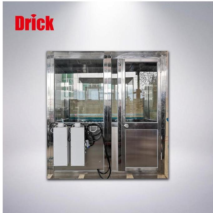
泄漏性测试系统是用于测试在一定的环境条件下，口罩（呼吸器）及防护服对气溶胶颗粒物的泄漏性防护性能。泄漏性测试采样真人测试，真人戴上口罩或面罩，站立于带一定浓度的气溶胶室内（测试仓内），口罩靠近人体嘴巴部位有采样管，可以采集口罩内的气溶胶浓度。按照测试标准的要求，人体完成一系列的动作，分别读取口罩内部及外部的浓度，计算每个动作的泄漏率及总体泄漏率。欧标测试，需要人体在跑步机上以一定的速度行走，来完成一系列的动作。防护服测试，类似与口罩的测试，需要真人穿戴防护服，进入测试仓内进行一系列的测试。防护服同样有采样管，采样防护服内外的气溶胶浓度，还能通入清洁空气到防护服内。
