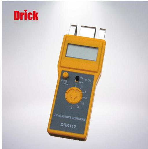
DRK112 纸张水分仪是引进国外先进技术在国内推出的高性能、数字化水分测量仪器。仪器采用高周波原理，数字显示，传感器与主机合为一体，设有 6 个档位，用来测量不同材质的含水率。
