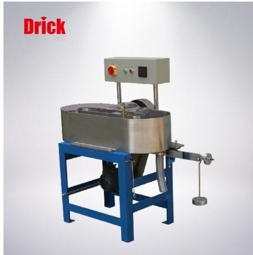
DRK504A 瓦利打浆机 (纸浆粉碎机) 是造纸实验室国际标准设备, 是研究制浆造纸工艺的必备设备, 该机通过飞刀辊与底刀产生的机械作用力, 将各种纤维浆料进行切断、压溃、揉搓、分裂、润胀和纤维细化, 同时对纤维产生细胞壁的位移和变形、初生壁和此生壁外层的破裂。
