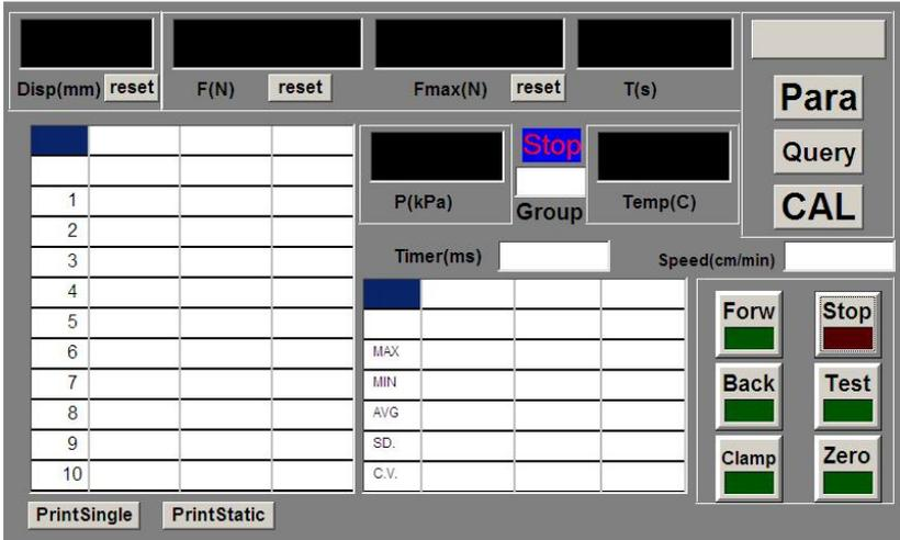
主试验界面如图所示，分为菜单区、试验数据显示区、试验结果显示区、控制按钮区、试验结果统计显示区等几个区域。触控批号输入框，在弹出的数字键盘上直接输入批号可手工改变批号。
