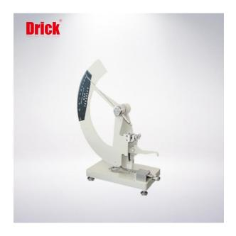
DRK108A 纸张撕裂度测定仪为撕裂强度测定的专用仪器,本仪器主要用于纸张撕裂度的测定,也可用于较低强度纸板的撕裂度测定,是造纸、包装、科研和产品质量监督检验等行业和部门理想的实验设备。
