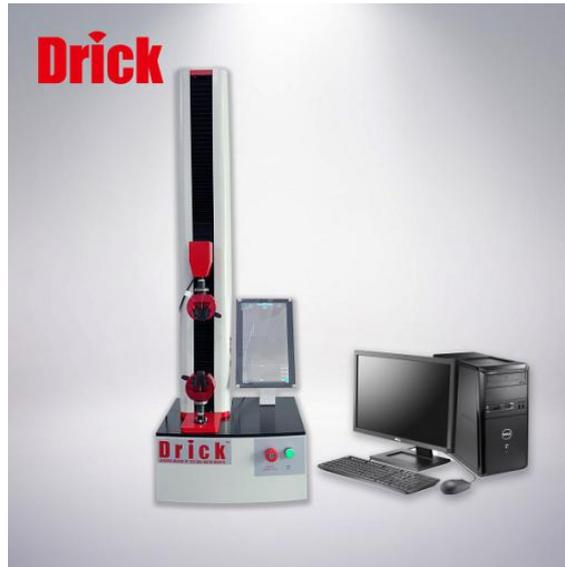
山东德瑞克自主研发，医用口罩防护服综合试验机，广泛应用于各种口罩强力类检测项目。符合国标、医药标准测试要求，全自动软件控制系统，满足数据储存、打印、对比。进口伺服电机搭载精密丝杠传动系统保证测试数据稳定性。
