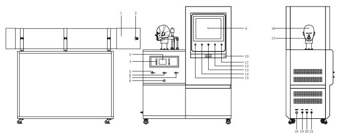
1 风筒、2 风速仪吸气采样口、3 分析仪显示屏 4、分析仪吸气流量计(左)、呼气流量计(右) 5 吸气 CO2 含量、6 呼出 CO2 含量、7 标定气体、8 二氧化碳浓度调节阀、9 触摸控制屏、10 键盘、11 电脑电源、12 分析仪电源、13 数据接口、14 电源指示、15 电源开关、16 头模 17 采样管、18 电源插座、19 试验用 CO2 接口、20 标定用 CO2 接口、21 标定用 N2 接口、
