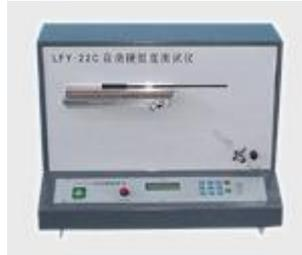
本仪器是按照国家标准 ZBW04003—87《织物硬挺度试验方法 斜面悬臂法》设计制造。适用于棉、毛、丝、麻、化纤等各类机织物、针织物和一般性的非织造织物、涂层织物等纺织品的刚柔性试验，同时也适合于纸张、皮革、薄膜等柔性材料的刚柔性试验。织物的弯曲性能是我们研究织物的挺括性、悬垂性、柔软性等项性质的重要物理参量，本仪器采用抗弯长度（亦称悬垂硬挺度）和抗弯刚度（亦称弯曲硬挺度）两个力学指标来表达“织物抵抗其弯曲方向形状变化的能力”
