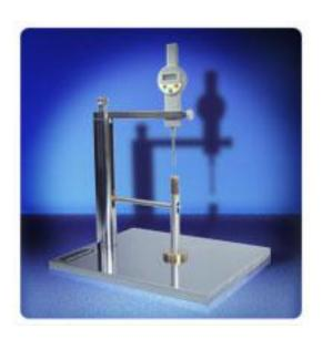
适用于各种机织物和针织、无纺布等厚度的测定,也可用其它均匀薄料的厚度测定。产品符合 GB3820-1999《纺织品和纺织制品厚度的测定》,IS05084-1996《纺织品和纺织制品厚度的测定》,IS09863-2005《土工布-在规定压力下厚度的测定》等标准。
